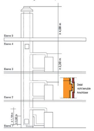
**Hinweise Mehrfachbelegung:**An das System MULTIKERAM LAS können bis zu drei Scheitholz-Feuerstätten raumluftunabhängig angeschlossen werden. Dabei gelten folgende Randbedingungen:
