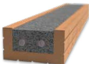
Der halbfertige und vorge-spannte Sturz vom Typ MDA ist ein in Keramischale einbetonierter Sturz. Durch die Breite von 12 cm kann er bei Außenwänden mit einer Wandstärke von 30, 38 und 45 cm, bei Innenwänden mit einer Wandstärke von 25, 30 und 38 cm und Zwischenwänden von 12 cm verwendet werden.
