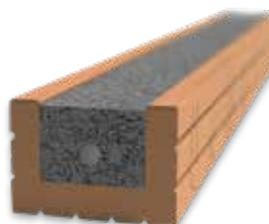
Der halbfertige und vorge-spannte Sturz vom Typ MDVA ist ein in Keramischale einbetonierter Sturz. Durch die Breite von 9 cm kann er bei Wandstärke von 10 bis 20 cm verwendet werden.
