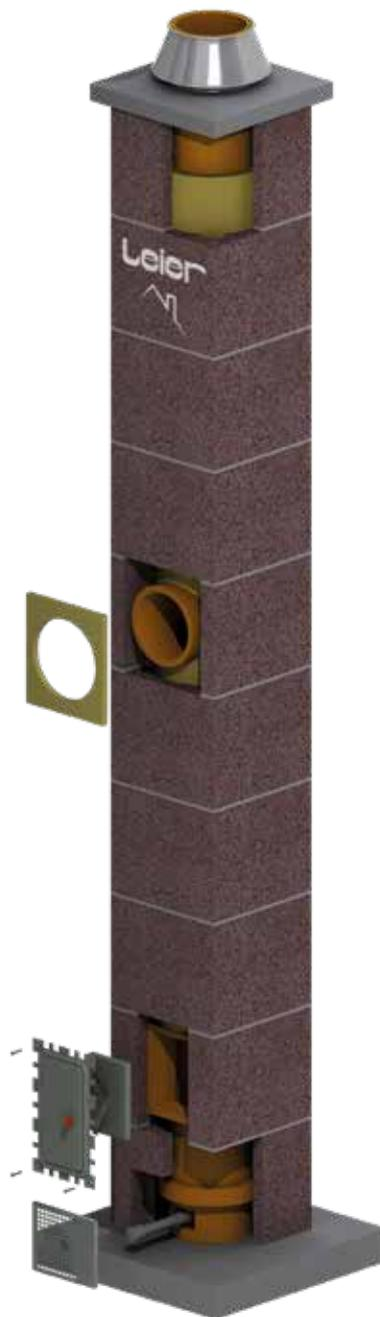
Das LSK-System ist ein dreischaliges Kaminsystem. Die Schalen bestehen aus einem Mantelstein in Leichtbeton, einer Ummantelung des Rohrs aus Mineralwolle für optimale Wärmeisolierung und dem temperatur- und säurebeständigem Schamottröhr.
