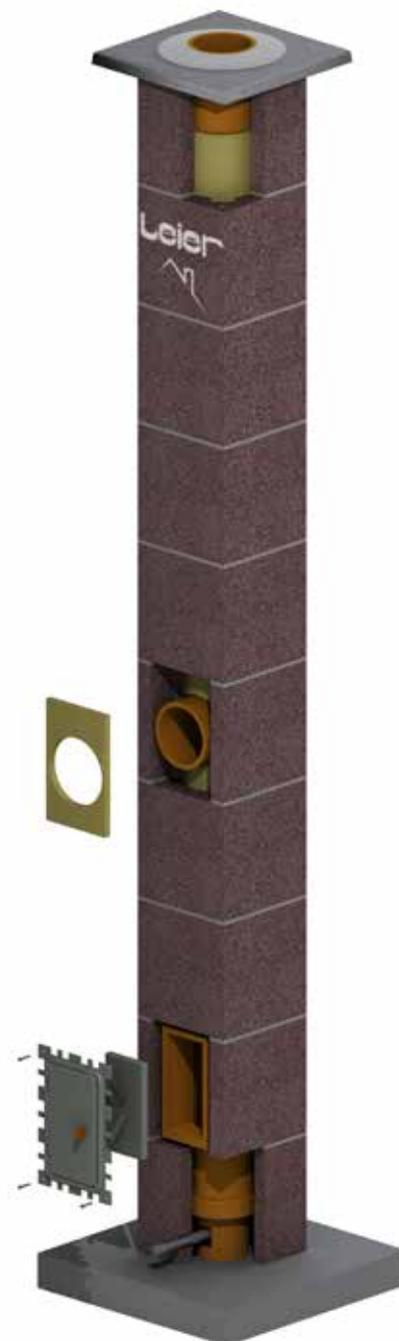
Das SMART-System ist ein dreischaliges Kaminsystem. Die Schalen bestehen aus einem Mantelstein in Leichtbeton, einer Ummantelung des Rohrs aus Mineralwolle für optimale Wärmeisolierung und dem temperatur- und säurebeständigem Schamottrohr.
